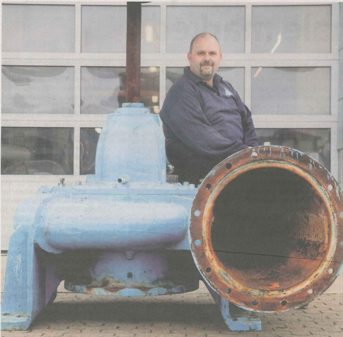
○ B. Christensens Maskinfabrik beskæftiger sig meget med servicering af vandværkspumper. Her en spildevandspumpe årgang 1936 fra Skovshoved på Sjælland, som er i Silkeborg til eftersyn.
